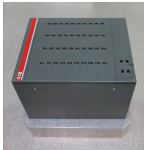
(d) Assembled *ABB PLC I/O Module*
